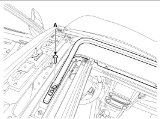
3. 使用螺丝刀或拆卸工具拆卸全景天窗导流板(A)。
